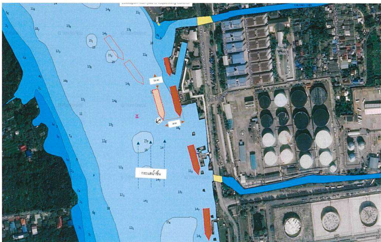
รูปที่ 6 การเทียบท่ากรณีน้ำขึ้น ท่า SL1
